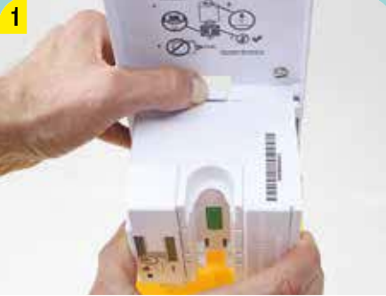
GEHÄUSE ÖFFNEN UND DIE ELEKTRONIKEINHEIT ABNEHMEN
