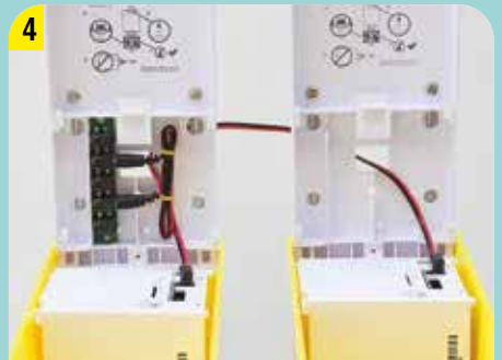
2. VERBINDUNGSKABEL MIT NIEDERVOLT-VERTEILER VERBINDEN (STECKPLATZ 4)
