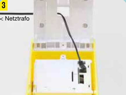
NETZKABEL MIT DER ELEKTRONIKEINHEIT VERBINDEN
