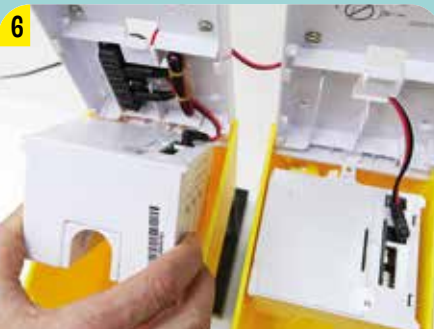
ELEKTRONIKEINHEIT WIEDER EINKLICKEN
