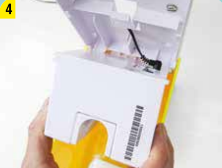
ELEKTRONIKEINHEIT WIEDER EINKLICKEN
