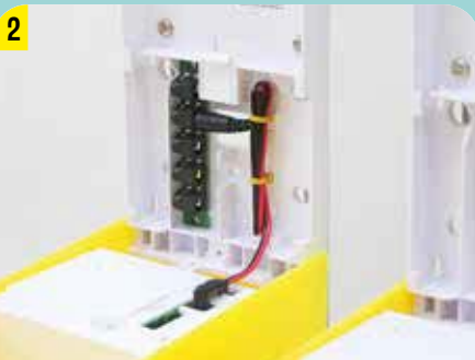
1. VERBINDUNGSKABEL MIT NIEDERVOLT-VERTEILER VERBINDEN (STECKPLATZ 2)
