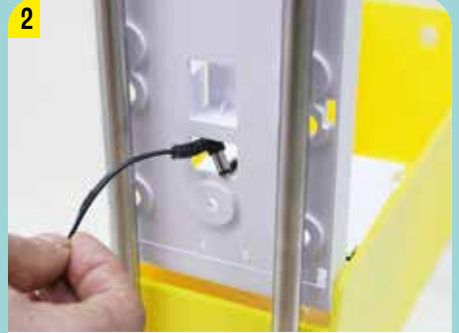
NETZKABEL VON HINTEN DURCH DIE ÖFFNUNG STECKEN
