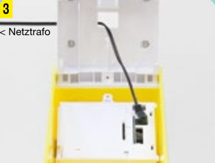
NETZKABEL MIT DER ELEKTRONIKEINHEIT VERBINDEN
