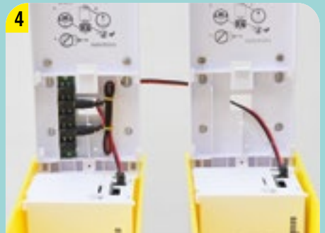
2. VERBINDUNGSKABEL MIT NIEDERVOLT-VERTEILER VERBINDEN (STECKPLATZ 4)
