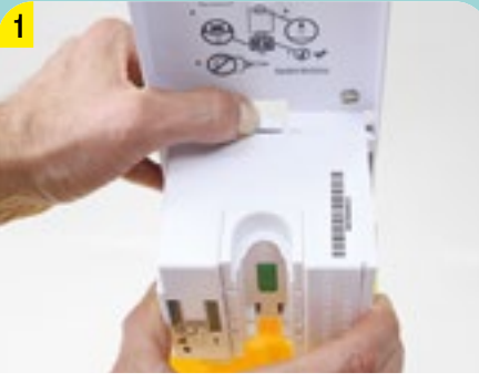
GEHÄUSE ÖFFNEN UND DIE ELEKTRONIKEINHEIT ABNEHMEN
