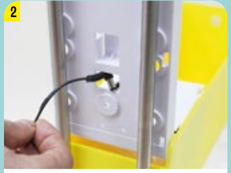
NETZKABEL VON HINTEN DURCH DIE ÖFFNUNG STECKEN
