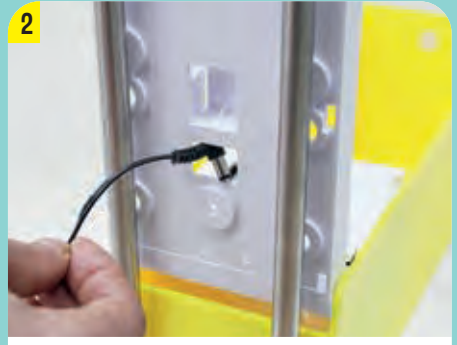
NETZKABEL VON HINTEN DURCH DIE ÖFFNUNG STECKEN
