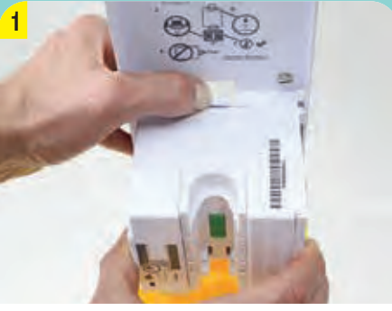
GEHÄUSE ÖFFNEN UND DIE ELEKTRONIKEINHEIT ABNEHMEN
