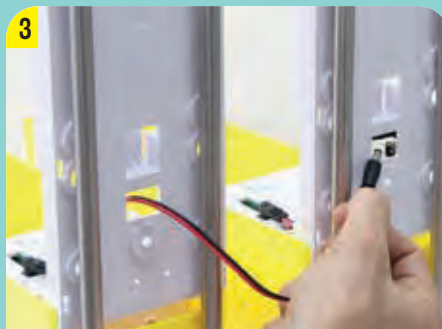
2. VERBINDUNGSKABEL MIT E-EINHEIT DES 2. SENSORSPENDERS VERBINDEN UND DURCH DIE ÖFFNUNGEN ZUM 1. SENSORSPENDER FÜHREN
