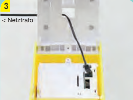
NETZKABEL MIT DER ELEKTRONIKEINHEIT VERBINDEN
