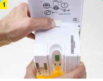
GEHÄUSE ÖFFNEN UND DIE ELEKTRONIKEINHEIT ABNEHMEN
