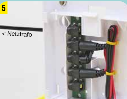
NETZKABEL VON HINTEN DURCH DIE ÖFFNUNG STECKEN UND MIT NIEDERVOLT-VERTEILER VERBINDEN (STECKPLATZ 3)
