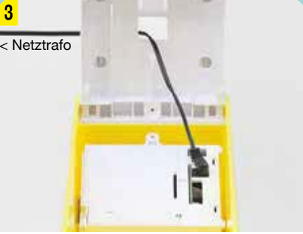
NETZKABEL MIT DER ELEKTRONIKEINHEIT VERBINDEN
