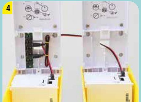
2. VERBINDUNGSKABEL MIT NIEDERVOLT-VERTEILER VERBINDEN (STECKPLATZ 4)
