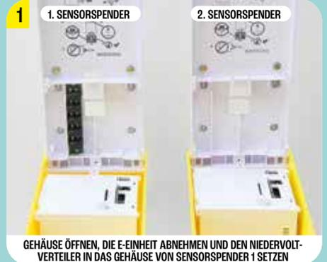
GEHÄUSE ÖFFNEN, DIE E-EINHEIT ABNEHMEN UND DEN NIEDERVOLT-VERTEILER IN DAS GEHÄUSE VON SENSORSPENDER 1 SETZEN
