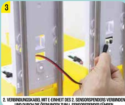
2. VERBINDUNGSKABEL MIT E-EINHEIT DES 2. SENSORSPENDERS VERBINDEN UND DURCH DIE ÖFFNUNGEN ZUM 1. SENSORSPENDER FÜHREN
