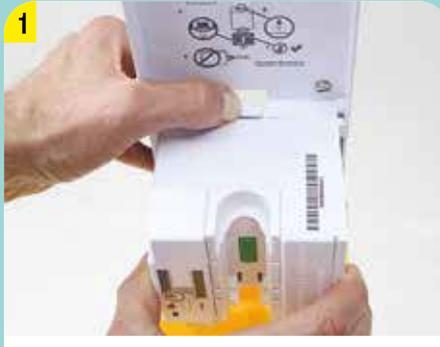
GEHÄUSE ÖFFNEN UND DIE ELEKTRONIKEINHEIT ABNEHMEN
