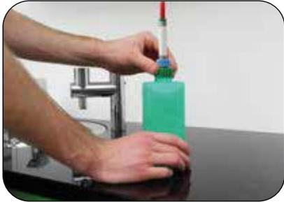
✓ Aufdrehen der Schlauchdosierpumpe inkl. Adapter
