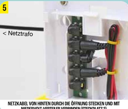
NETZKABEL VON HINTEN DURCH DIE ÖFFNUNG STECKEN UND MIT NIEDERVOLT-VERTEILER VERBINDEN (STECKPLATZ 3)
