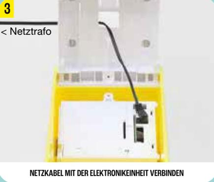
NETZKABEL MIT DER ELEKTRONIKEINHEIT VERBINDEN
