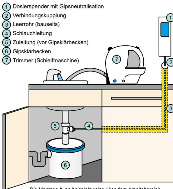
Die Montage kann beispielsweise über dem Arbeitsbereich angebracht werden, jedoch muss hier eine Zuleitung zum Gipsklärbecken vorhanden sein. Dies erfolgt meist durch ein Leerrohr in der Wand.
