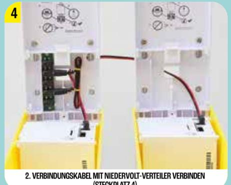
2. VERBINDUNGSKABEL MIT NIEDERVOLT-VERTEILER VERBINDEN (STECKPLATZ 4)
