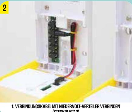
1. VERBINDUNGSKABEL MIT NIEDERVOLT-VERTEILER VERBINDEN (STECKPLATZ 2)
