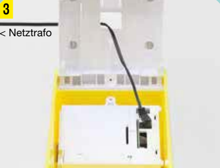
NETZKABEL MIT DER ELEKTRONIKEINHEIT VERBINDEN
