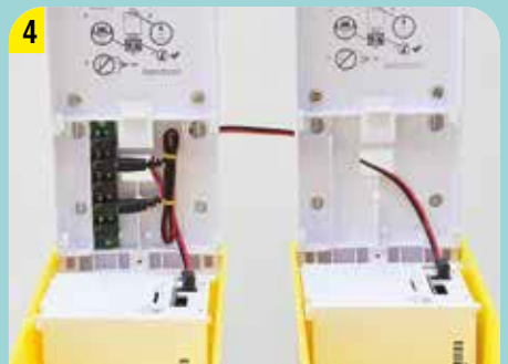
2. VERBINDUNGSKABEL MIT NIEDERVOLT-VERTEILER VERBINDEN (STECKPLATZ 4)
