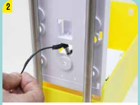
NETZKABEL VON HINTEN DURCH DIE ÖFFNUNG STECKEN
